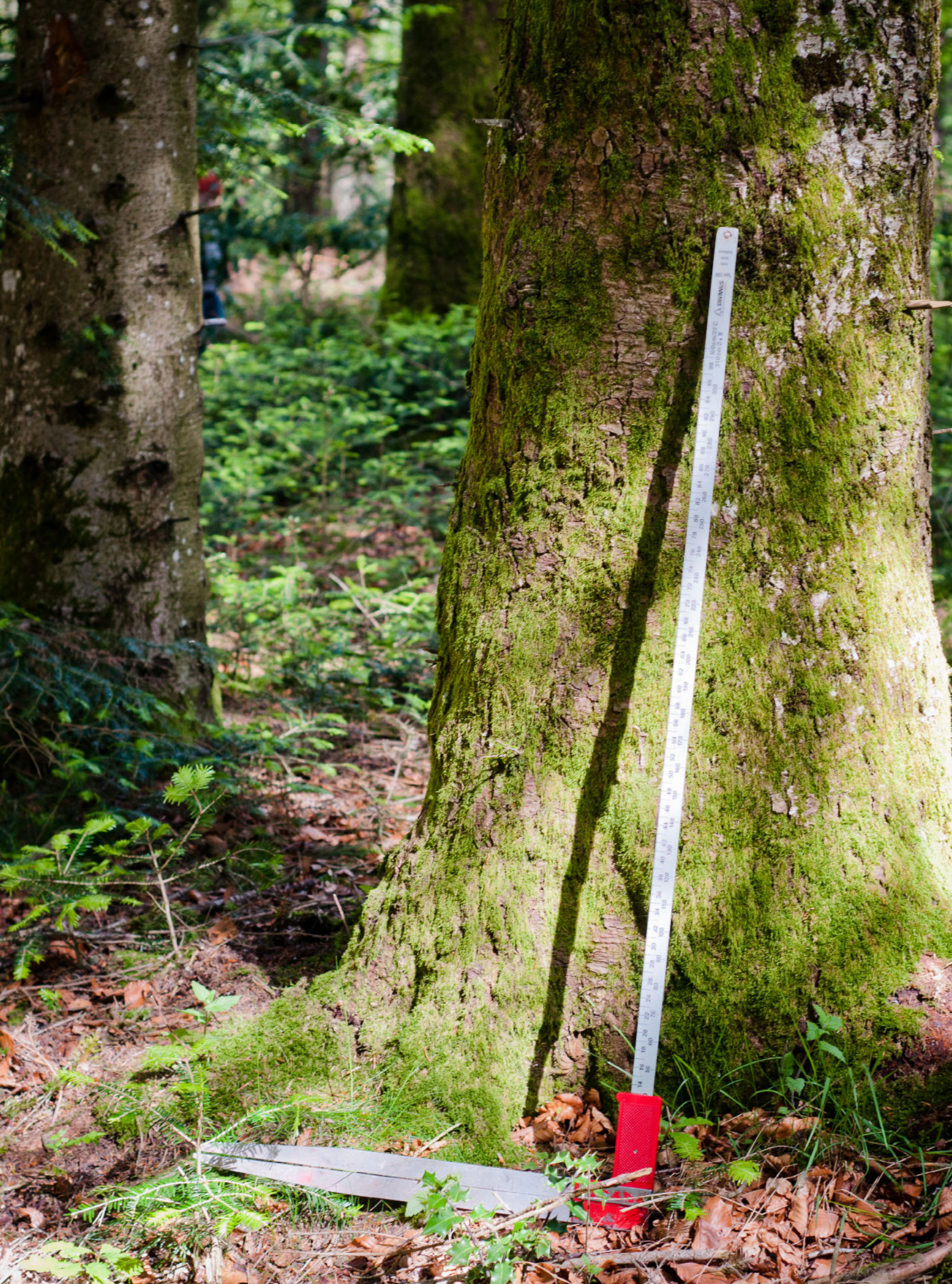
Le compas forestier est l'instrument de base du sylviculteur. Il lui permet de mesurer le diamètre à hauteur de poitrine du tronc d'un arbre. Il existe des modèles classiques mécaniques et des modèles électroniques.
